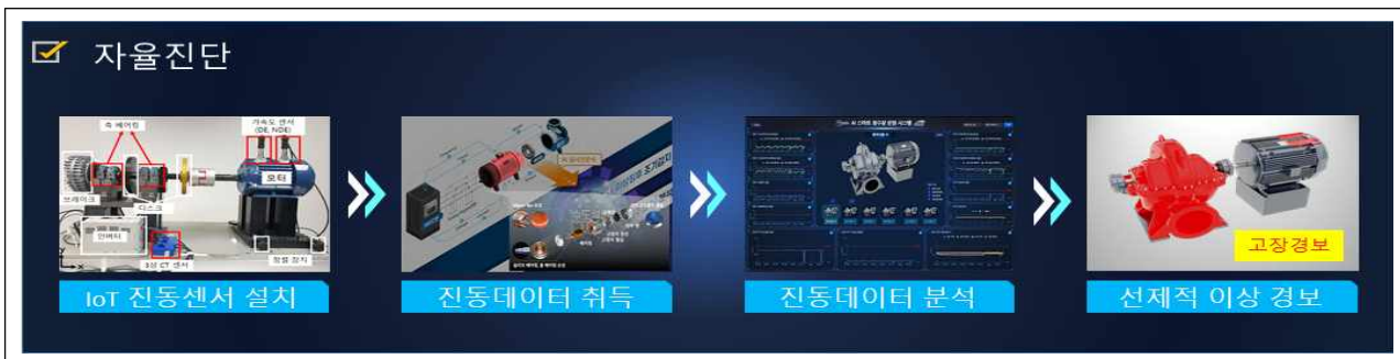
<그림5> AI정수장 설비 예지보전(PMS)
